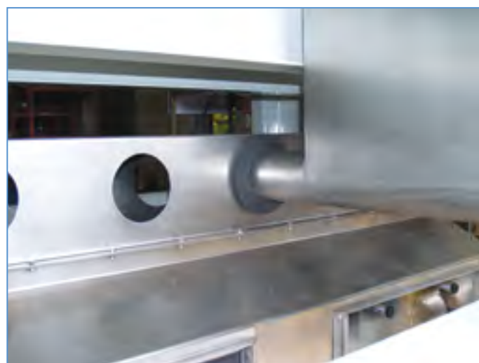
Питатель устанавливается уплотнителями сверху весов.
