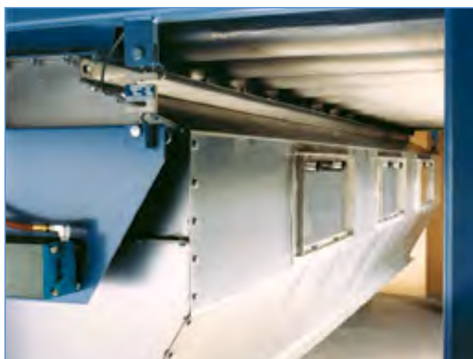
Люки обслуживания позволяют производить легкую чистку и инспекцию весового хоппера.
