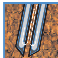
Движение воздуха и материала в контейнер для сбора проб
